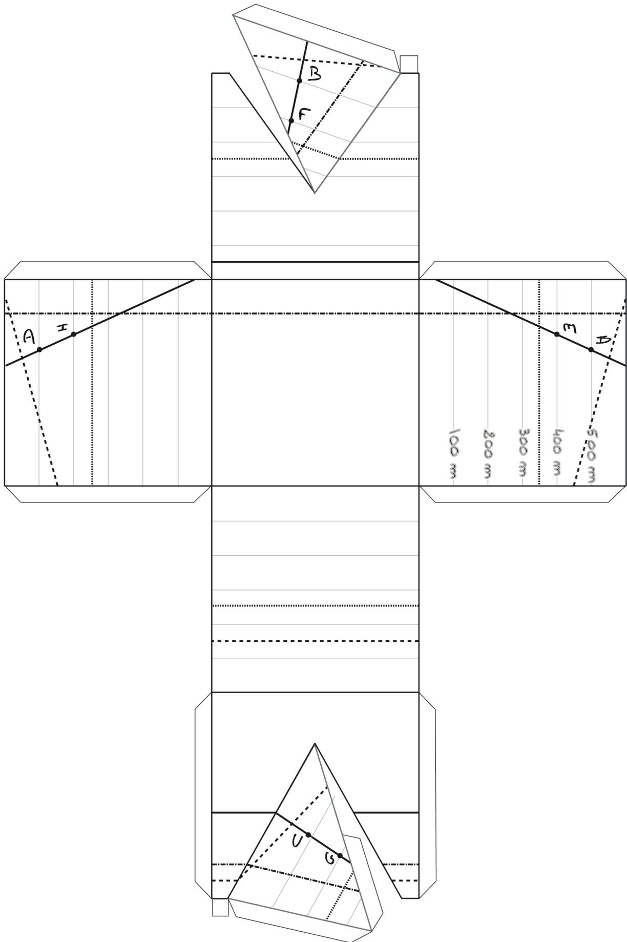
Figure 14 : Détermination de la valeur du pendage d'une couche par trigonométrie.
